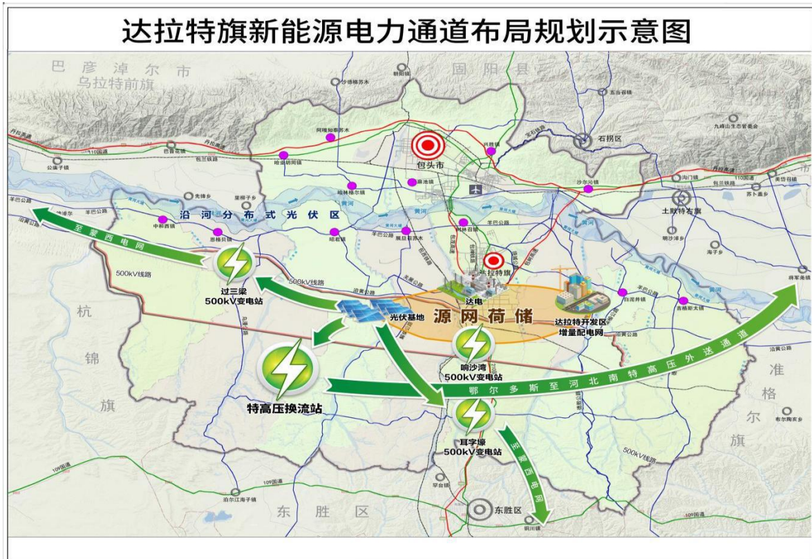
图 5 新能源电力网架结构图
